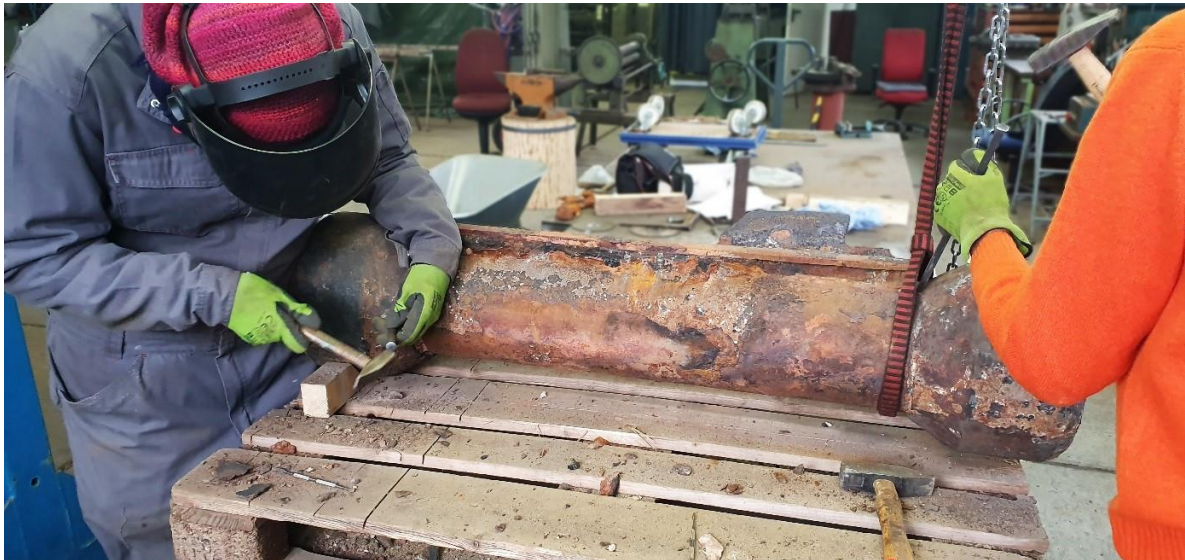
Manuelle Reinigung: bei stärker anhaftende Gesteinsanhaftungen wurde auf Hämmer und Meißel zurückgegriffen, 24.01.2020 (Foto: Thomas Köhler)
