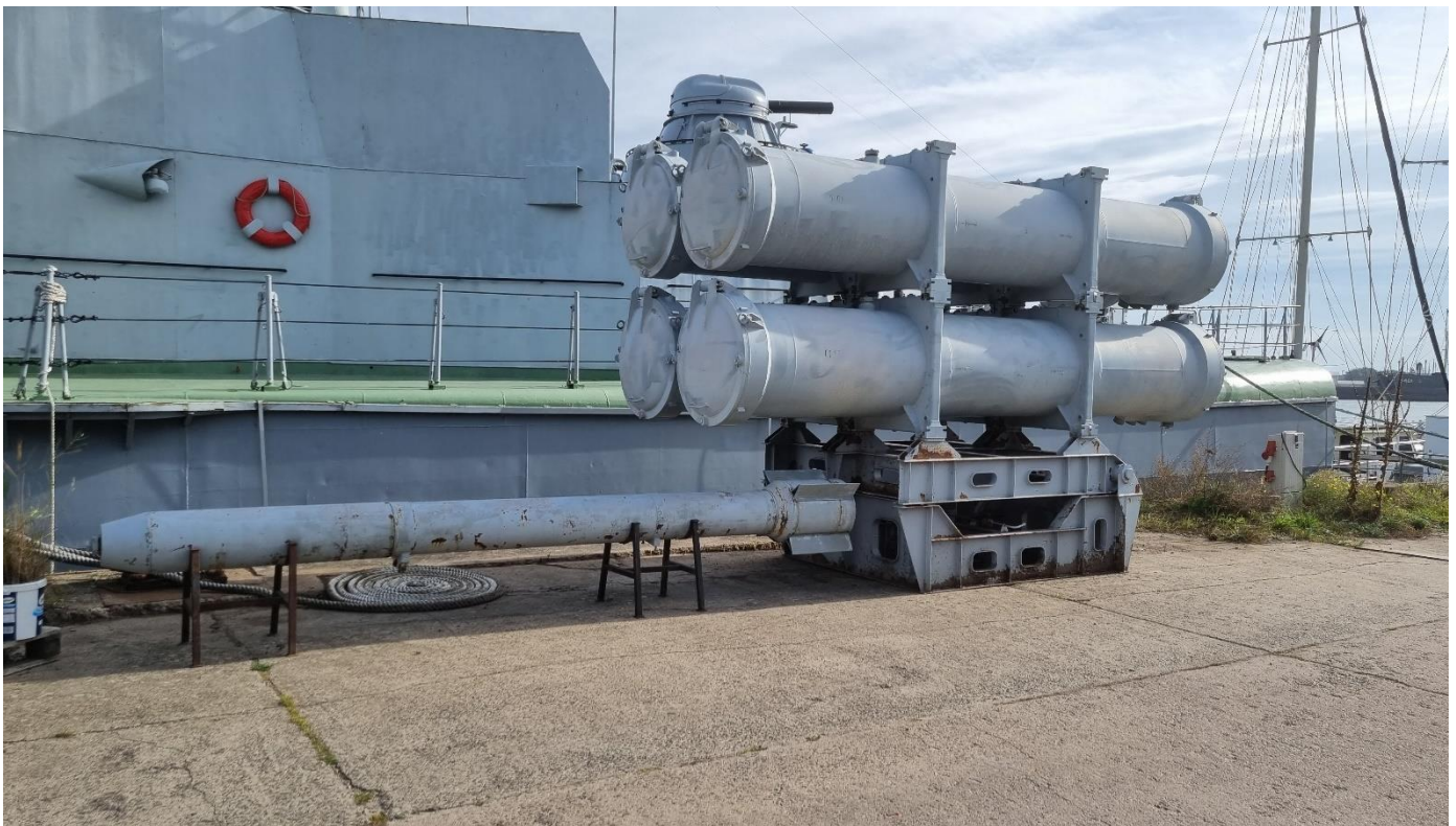
Transport- und Startcontainer Projekt 1520 mit Raketendummie
