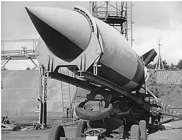
Aufrichten des V5 (links), Dr. Walter Thiel vor dem aufgestellten V5 (rechts); Video-Screenshots
