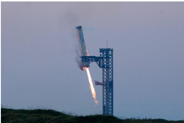
Die erste Stufe der Rakete wird von den Armen des Versorgungsturms aufgefangen Reuters
