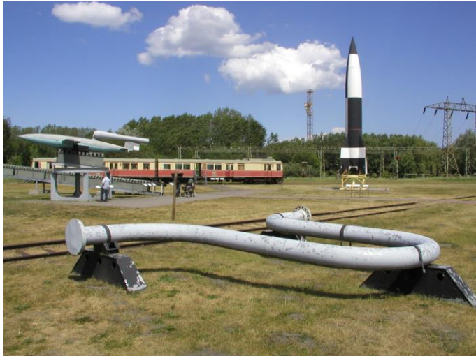
Dehnungsbogen zum Längenausgleich als Exponat im HTM
