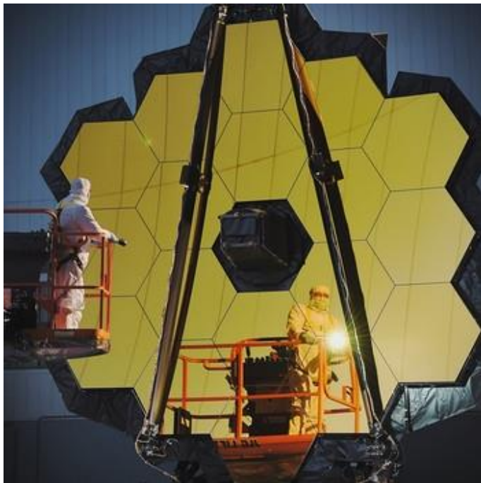
Der Hauptspiegel des James Webb- Teleskops bei Tests in der Montagehalle.
