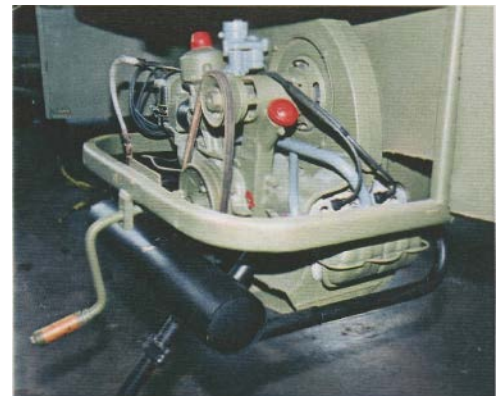
Der VW-Motor des Meillerwagens zum Antrieb der Hydraulikpumpe in fast neuem Zustand
